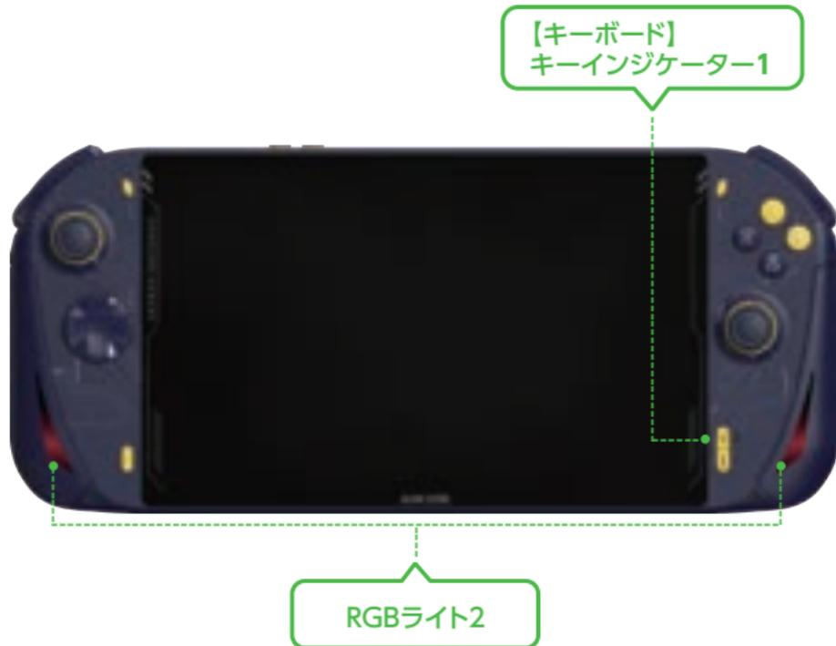
1. ゲームコントローラモードの場合インジケータLEDは消灯し、キーボード&マウス モードの場合、インジケータLEDはオレンジ色になります。
